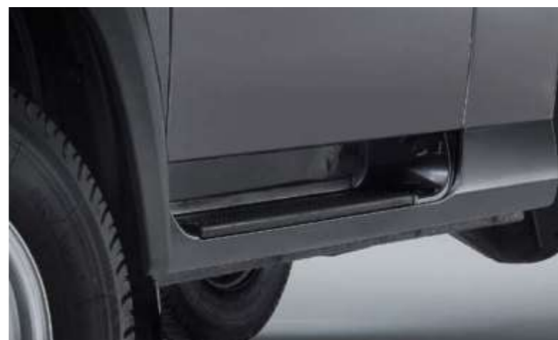
Подножки с противоскользящим покрытием
