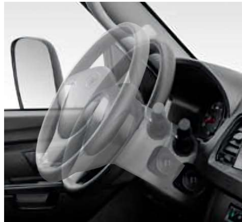
Регулировка руля по высоте и по вылету
