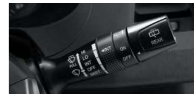
Правый подрулевой переключатель с регулировкой паузы стеклоочистителя
