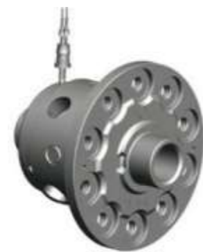
Блокировка дифференциала заднего моста
