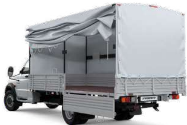
Платформа с возможностью отдельного открывания бортов
