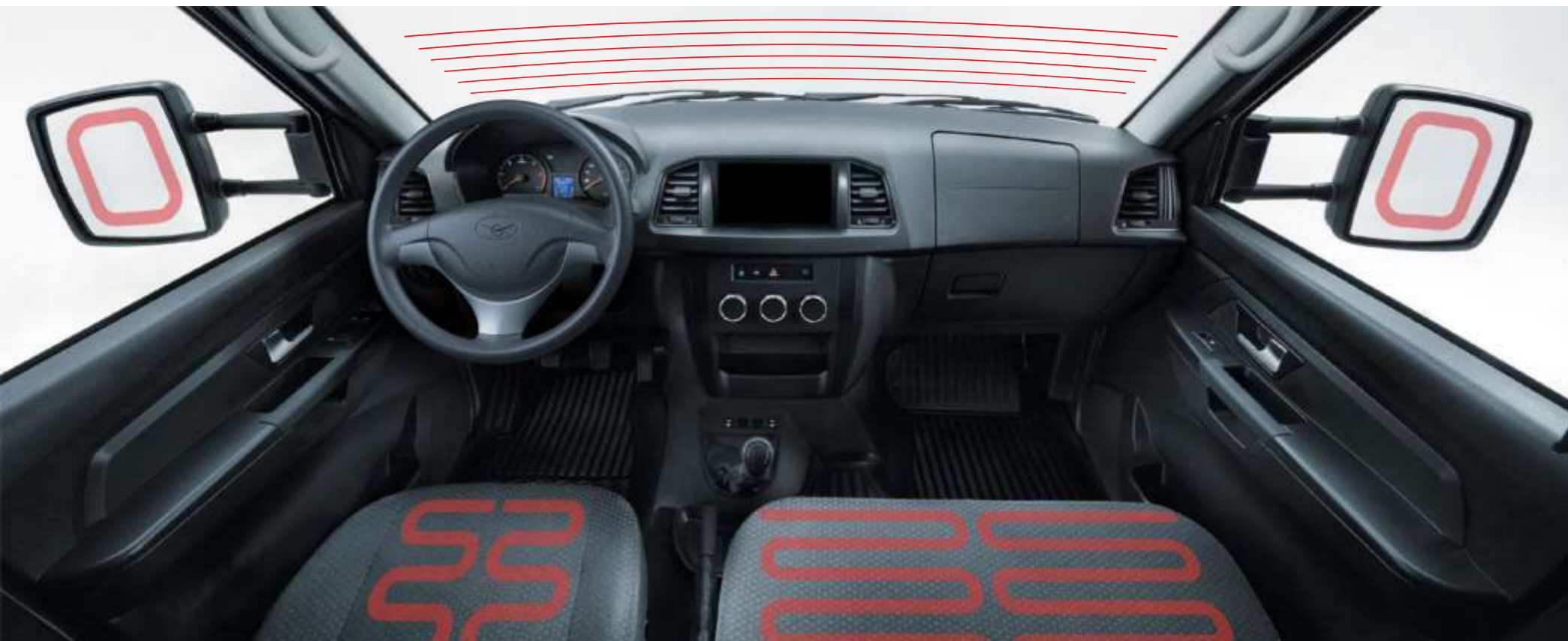
Подогрев зеркал заднего вида. Подогрев ветрового стекла, подогрев сидений в составе пакета «Комфорт».
