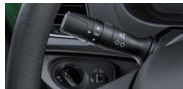
Современные подрулевые переключатели и блок управления светом
