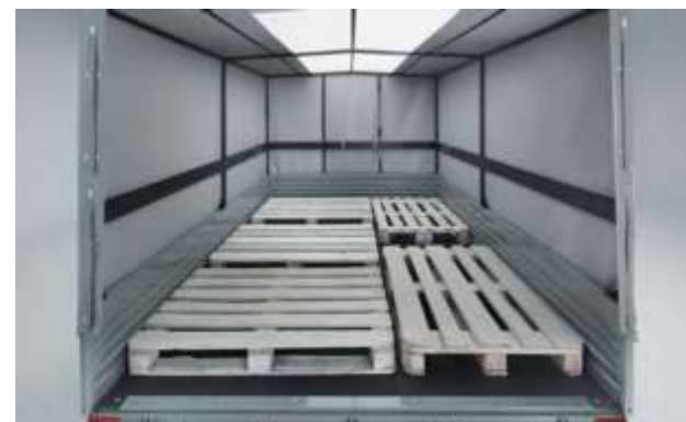
Светопроницаемая крыша. Прочный проклеенный тент
